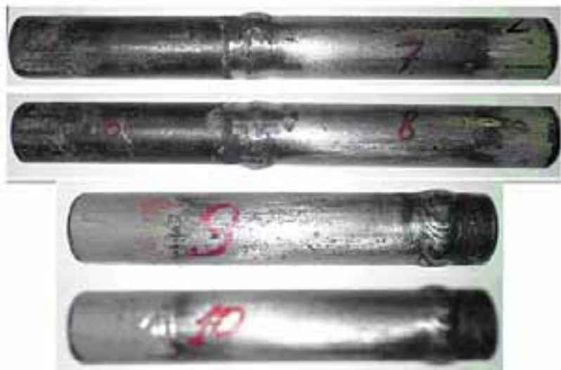
Рис. 8. Контрольные образцы для проведения испытаний комплексом средств неразрушающего и разрушающего контроля
