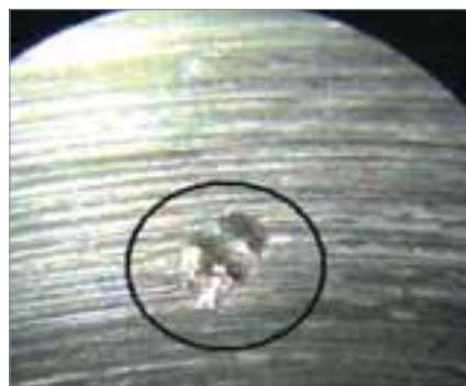
Дефект № 8 (шлаковое включение)
