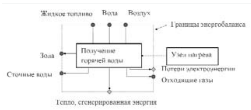
Рис. 4. Следующая декомпозиция с общим балансом. Здесь показана отдельная технологическая операция (производство горячей воды)
