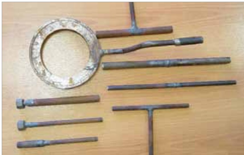
Рис. 1. Основные типы сварных соединений трубных проволочек КИП нефтехимических производств
