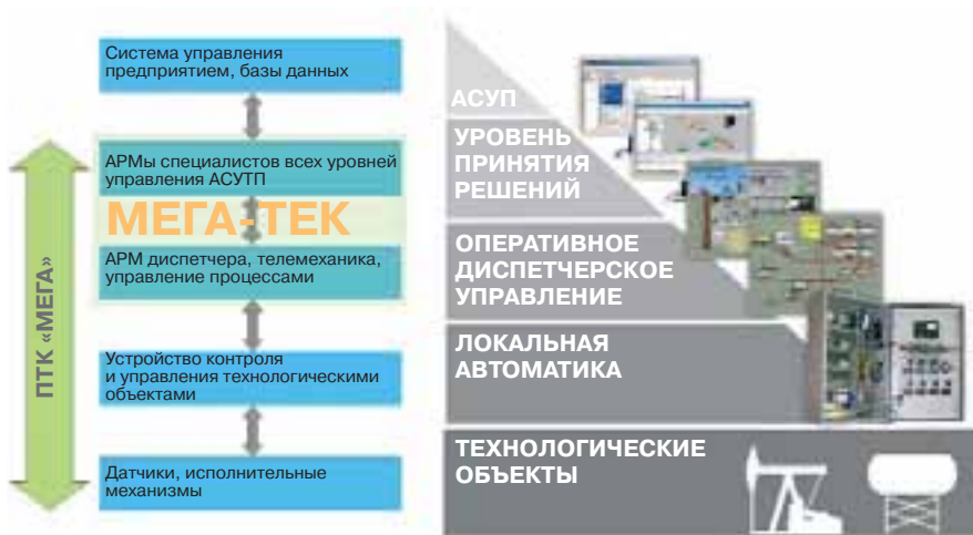
Рис. 2. Уровень "Мега-Тек" в иерархии управления производством
