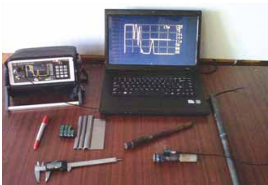
Рис. 3. Установка для ультразвукового контроля с компьютерной обработкой акустического сигнала
